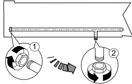
Ad installazione effettuata controllare, con una soluzione di acqua saponata, che non esistano perdite nei punti di raccordo.
